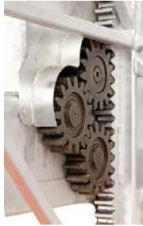
ラック・アンド・ピニオン 高強度・高精度を誇っています
