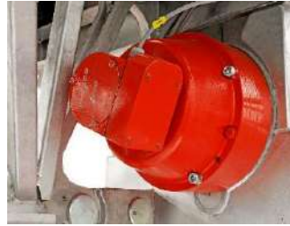
安全ブレーキ 簡単に作動テストが行える ガバナブレーキを装備しています
