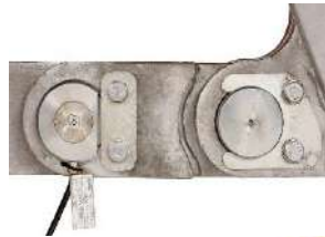
偏荷重モーメントセンサー 偏荷重を検知し、オーバーロード の際、インターロッキングを働か せます
