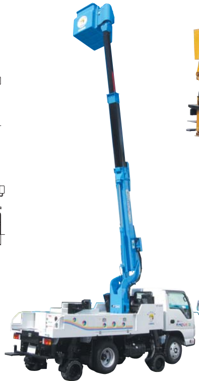
●YS100Mスカイムバー ※モバイルローラーで作業中そのまま走行可能です。 注) 保有地区が限られています
