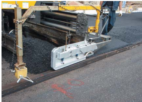
熱風式サイドプレート：合材付着防止に
