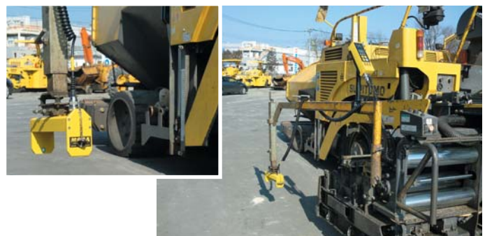
MOBAソニックスキー：5個の超音波センサーで進行方向の平均した路盤を検出
