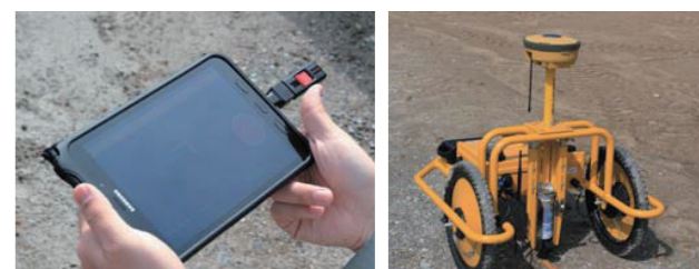
座標データをタブレットに入力すれば自動走行しながらスプレーマーキングします
