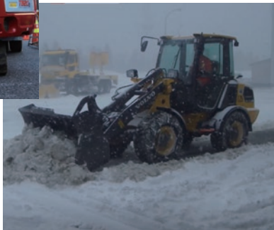
▼過酷な除雪作業現場で稼働する電動ホイールローダ
