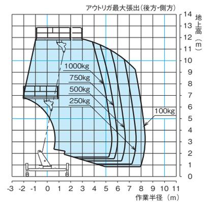
作業床各部の積載荷重
