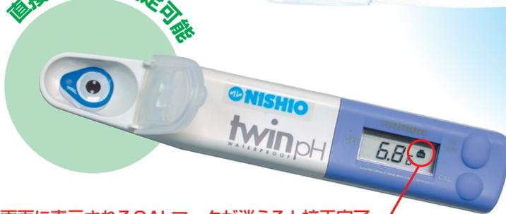
画面に表示されるCALマークが消えると校正完了
