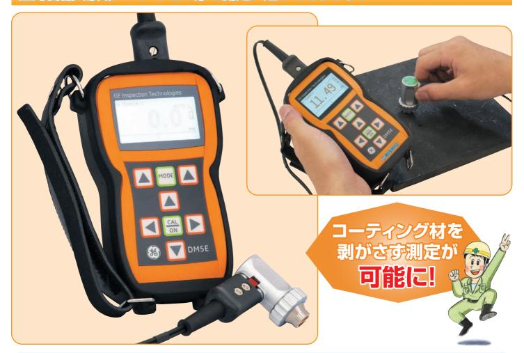
◆ 標準構成内容 ◆ 超音波厚さ計 DM5E 本体・標準探触子DA501EN ラバーケース・単3アルカリ乾電池 2本・カプラント液(50cc)・キャリングケース・取扱説明書
