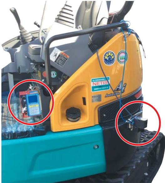
独自のセンサーで車両後部の障害物を検出し、ブザー音と本体内蔵LEDで危険を知らせ、安全運行をサポートします！
