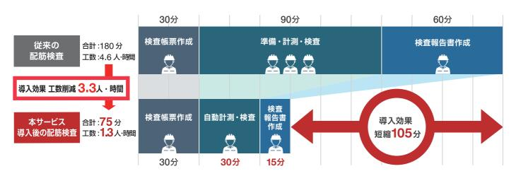
配筋検査帳票作成〜検査〜報告書作成まで、手作業による転記なく自動で実施可能です。 従来の配筋検査と比較して検査時間を約60%(※6)短縮し作業を効率化します。 施工管理システムとの連携も可能です。(※7)
