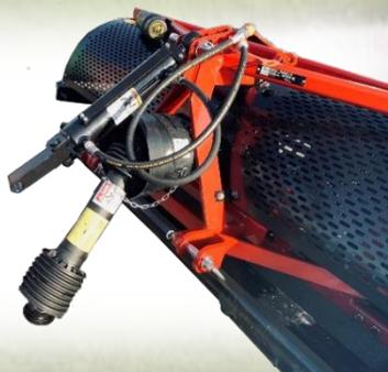
・油圧式リモート深度調整装置付き。エアレーションの深さをトラクターを降りずに油圧操作で楽々。
