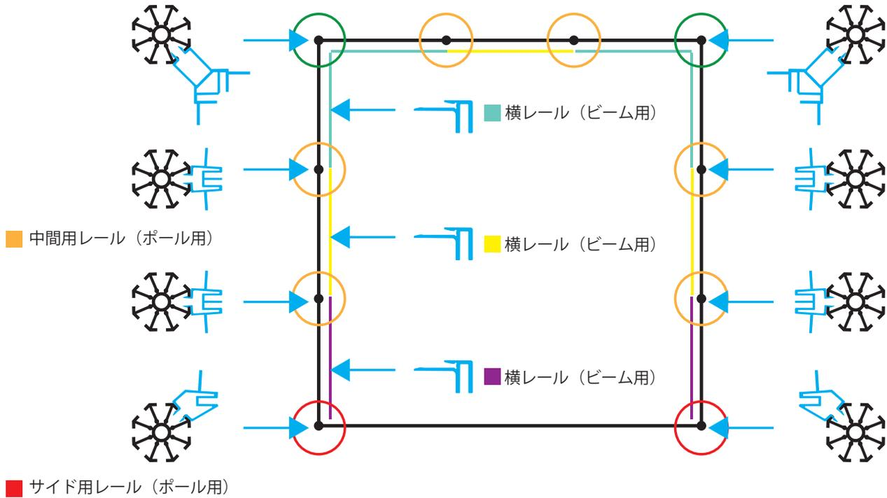
標準ブースを設置後に、■角柱用レールを角のポールに引っ掛けてください。45度にして挿入します。
