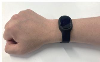
作業員の体調変化や、周辺の暑さ指数をPicoCELAを経由してクラウドで管理します。腕時計型ウェアラブルセンサーで、作業員一人ひとりの個別データを計測し、設定した値に達すると、異常と判断し管理者に通知します。早期の対応が可能となり熱中症等の予防にご活用いただけます。
