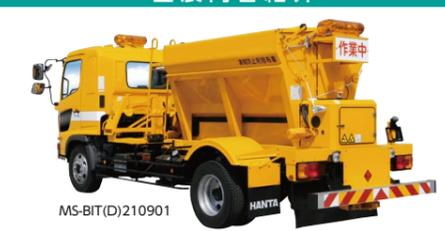
ベルトコンベヤを採用し確実に安定した搬送量を実現した散布車MS-25BIT(D)とお客様より要望の多かったホッパー内凍結防止剤の詰まりを解消するパイプリーク機能を搭載した散布機MS-03HVを展示しております。
