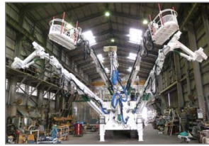
大断面对応型エレクター付 コンクリート吹付機 (ニシオT&M)
